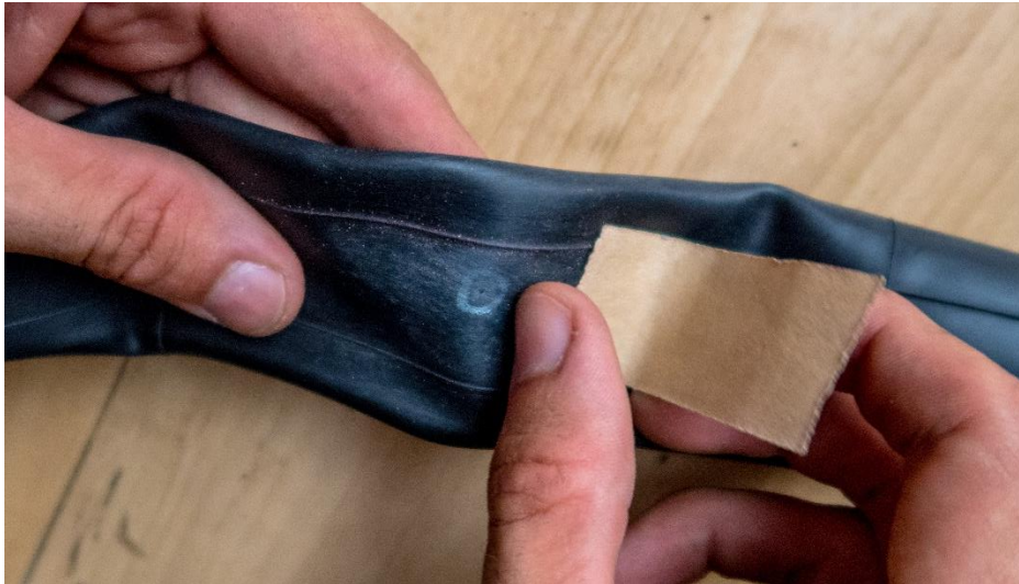
Obrázek č. 32: Příprava duše (zdroj: vlastní)
