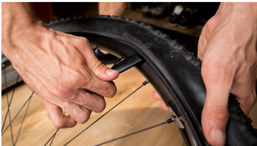
Obrázek č. 27: Sejmutí pláště (zdroj: vlastní)
