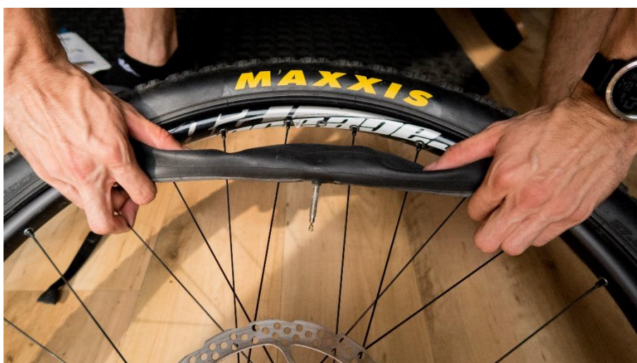
Obrázek č. 28: Vyjmutí duše (zdroj: vlastní)
