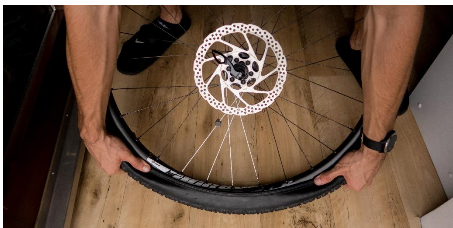
Obrázek č. 30: Nasazení pláště (zdroj: vlastní)
