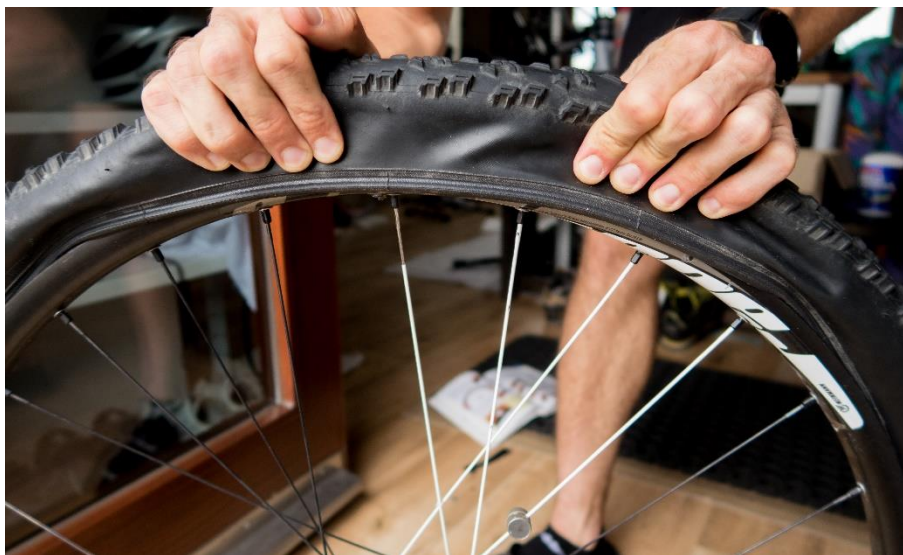
Obrázek č. 31: Přetažení pláště přes ráfek (zdroj: vlastní)
