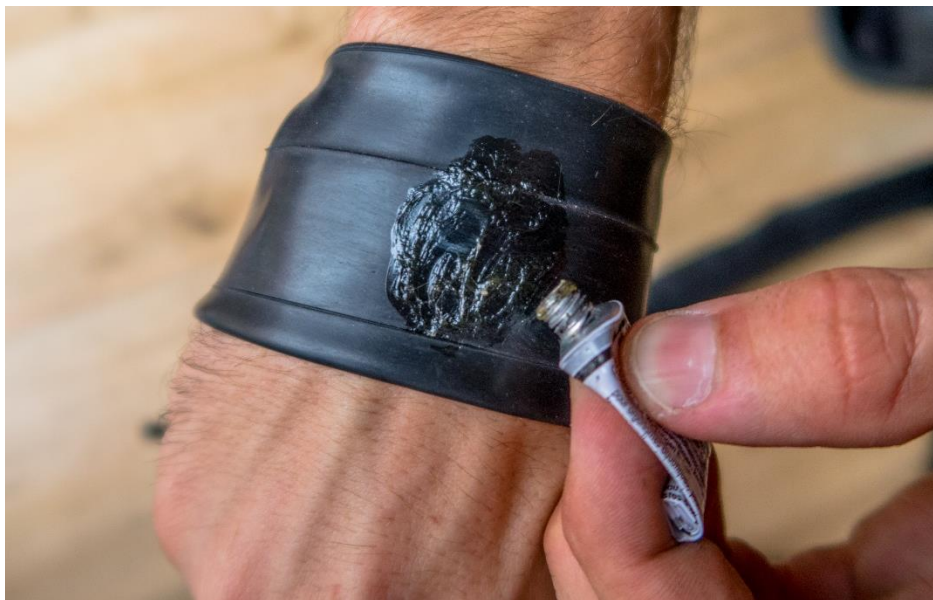
Obrázek č. 33: Nanesení lepidla (zdroj: vlastní)
