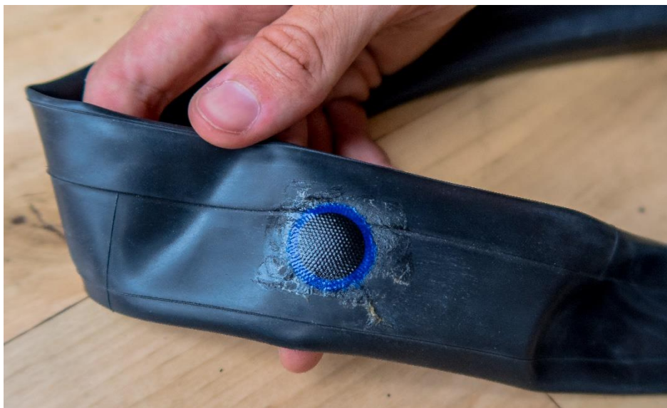
Obrázek č. 34: Přelepení dírky (zdroj: vlastní)
