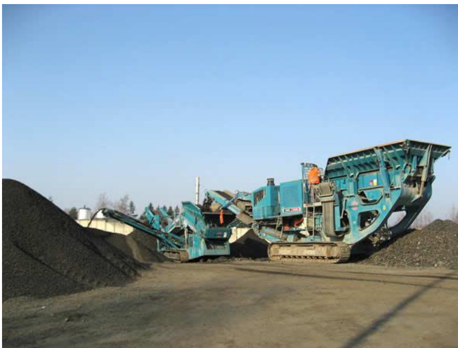
Obr. 14 – Recyklační zařízení pro recyklaci stavebního a demoličního odpadu
