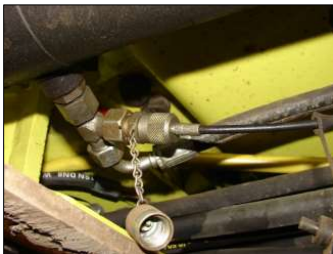
Obrázek 32: Sonda pro měření tlaku na hydromotoru řízení
