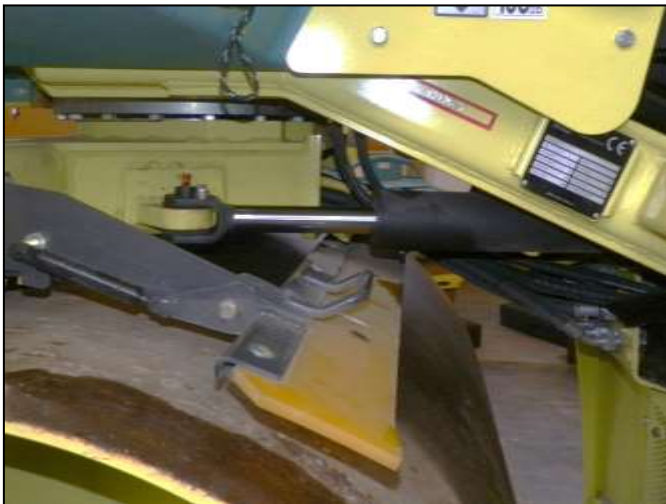
Obrázek 29: Lineární hydraulický motor řízení
