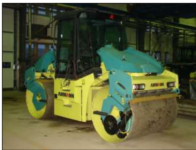
Obrázek 31: Stroj osazený měřicími body
