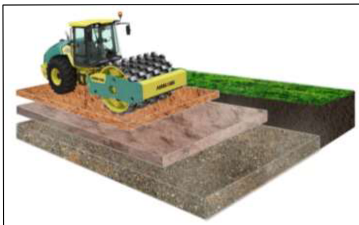
Obrázek 2: Oblast použití tahačového silničního válce s ježkovým běhounem
