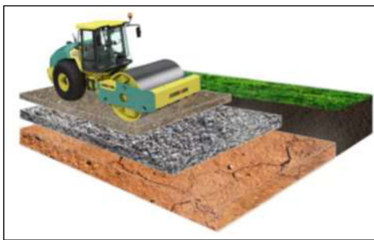
Obrázek 1: Oblast použití tahačového silničního válce s hladkým běhounem
