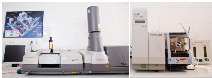
Obr. č. 17. Ukázka přístrojového vybavení Nexus 670 FT-IR, Exstar TG/DTA, převzato a upraveno z rcptm.com
