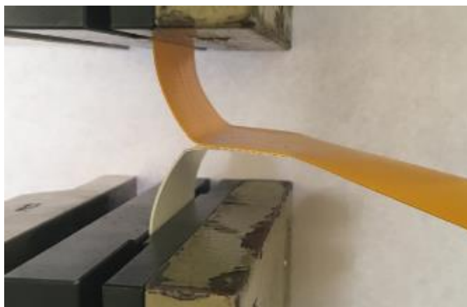
Obrázek 17: Testování přilnavosti technické textilie k výztuze.
