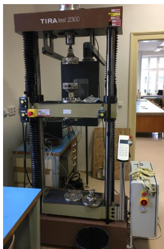
Obrázek 10: Zařízení na měření pevnosti materiálu TIRATEST 2300.
