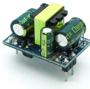
Obr 2.9: AC/DC měnič 5 V 700 mA
