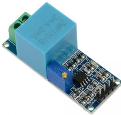
Obr 2.4: Napěťový transformátor ZMPT101B [6]
