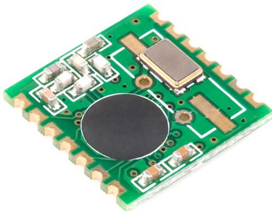
Obr 2.6: Komunikační modul RFM12B [11]
