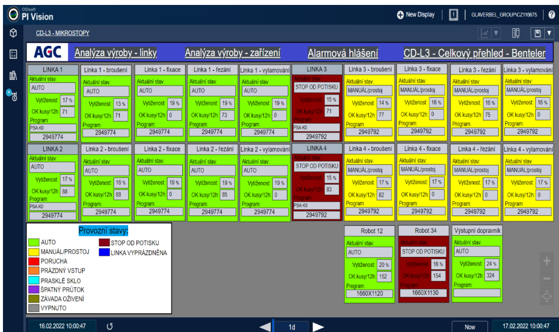
Obrázek 14 - Vizualizační obrazovka pro sledování stavu linek/zařízení Zdroj: Autor
