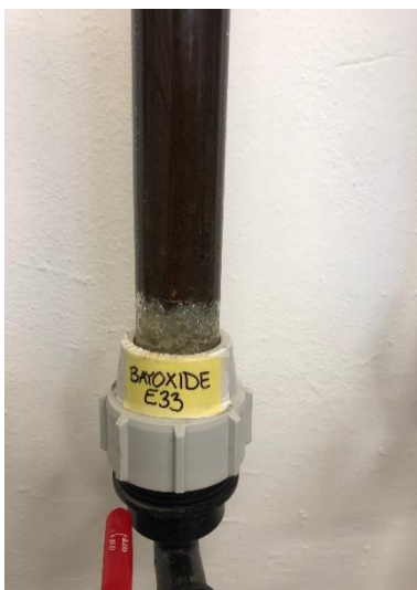
Obr. 5.8 Drenážní vrstva Bayoxide E33 [autor]
