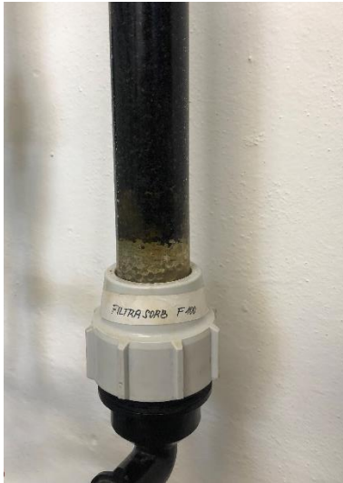
Obr. 5.6 Drenážní vrstva Filtrasorb F100 [autor]
