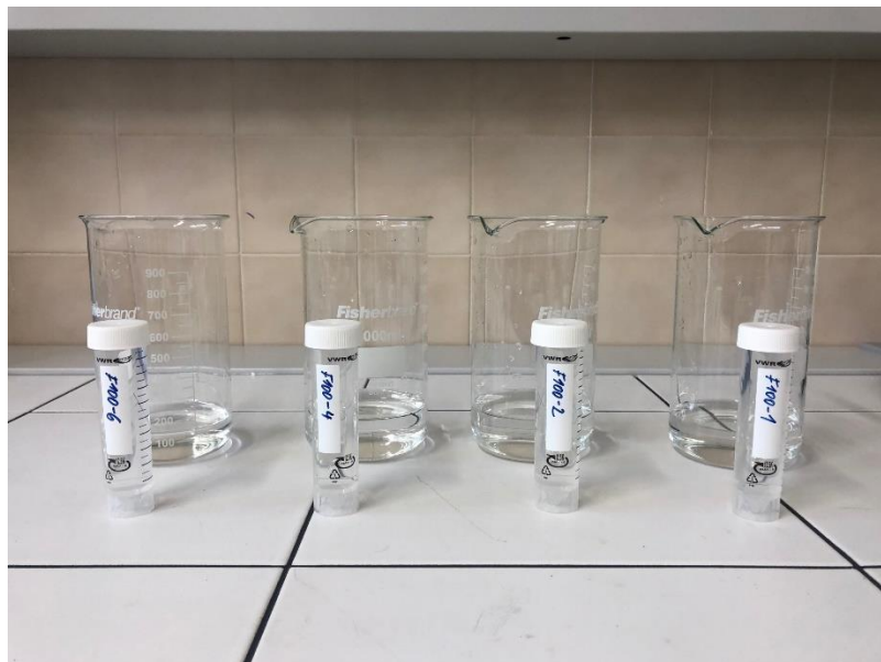
Obr. 5.15 Odebrané vzorky filtrované přes Filtrasorb F100 [autor]
