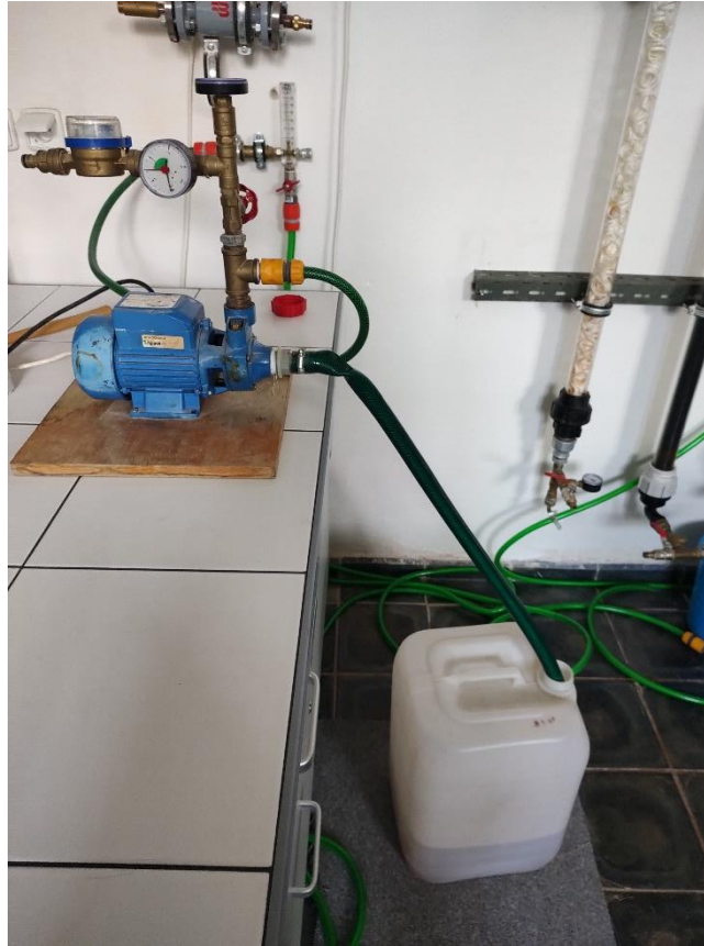
Obr. 5.13 Barel s modelovou vodou a čerpadlo [autor]
