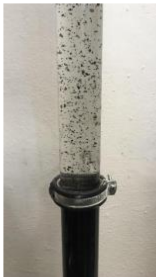
Obr. 5.11 Praní filtrační kolony u Filtrasorbu F100 [autor]
