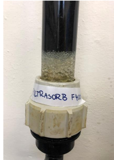
Obr. 5.7 Drenážní vrstva Filtrasorb F400 [autor]
