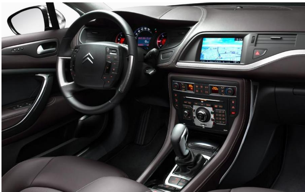
Obrázek 19: Nevhodný způsob rozmístění tlačítek (Citroen C5)
