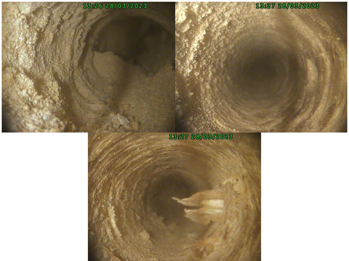
Obrázky 3.4.3 – 3.4.5: Snímky vrtaných sond pořízené mikrokamerou endoskopu.
