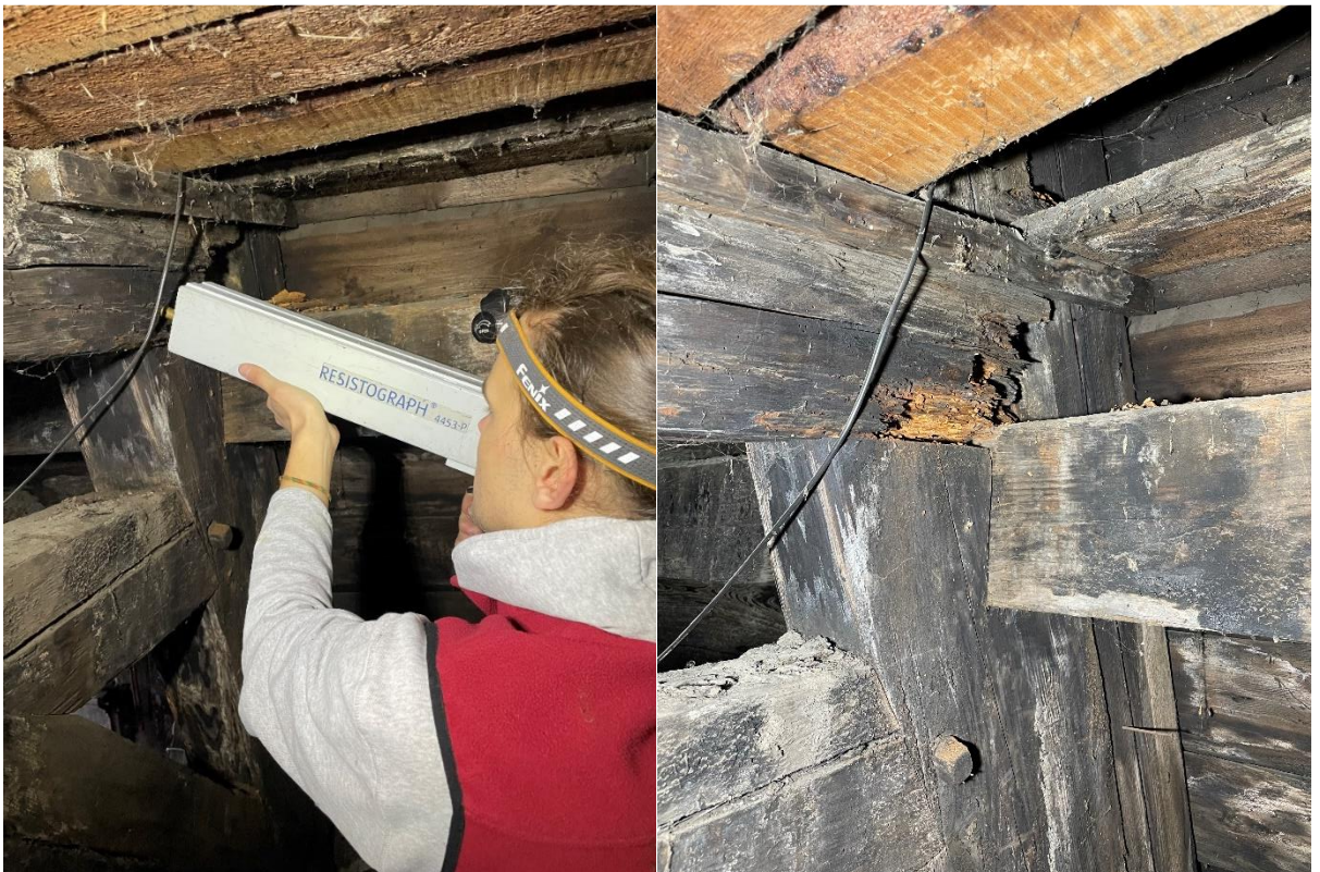
Obrázky 3.9.2 a 3.9.3: Měření pomocí Resistographu (vlevo), celkový pohled na vyšetřovaný prvek (vpravo).
