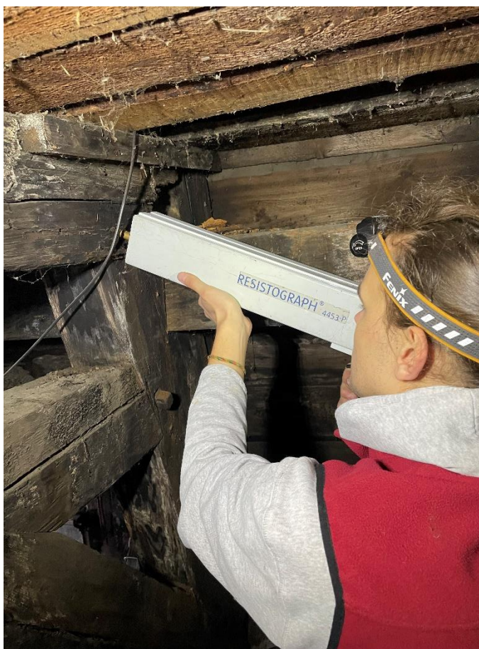
Obrázek 5.4.1.1: Měření poškozeného prvku pomocí Resistographu.
