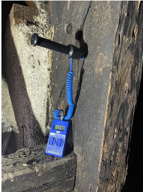
Obrázek 5.1.1.1: Stanovení vlhkosti pomocí odporového vlhkoměru.
