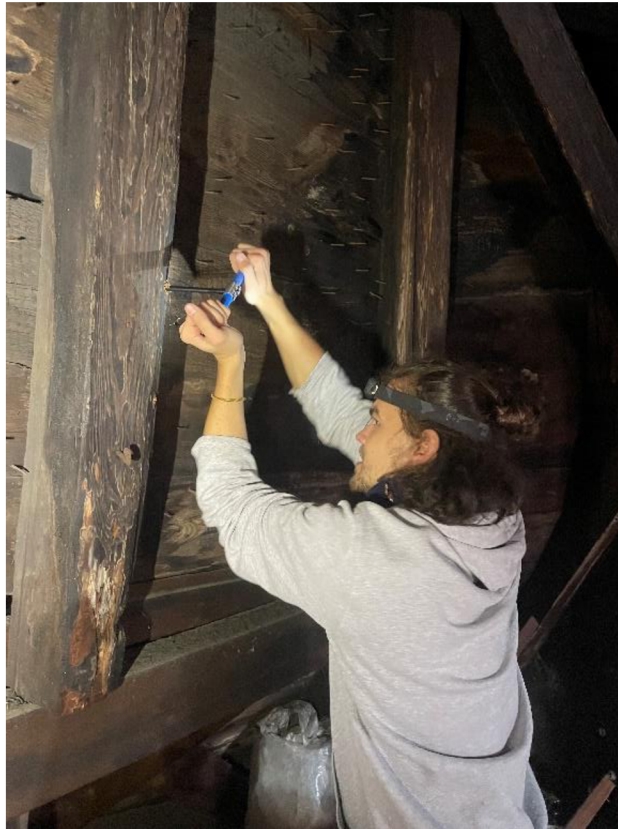
Obrázek 5.2.1.1: Odběr vzorku pro dendrochronologické datování pomocí Presslerova vrtáku.
