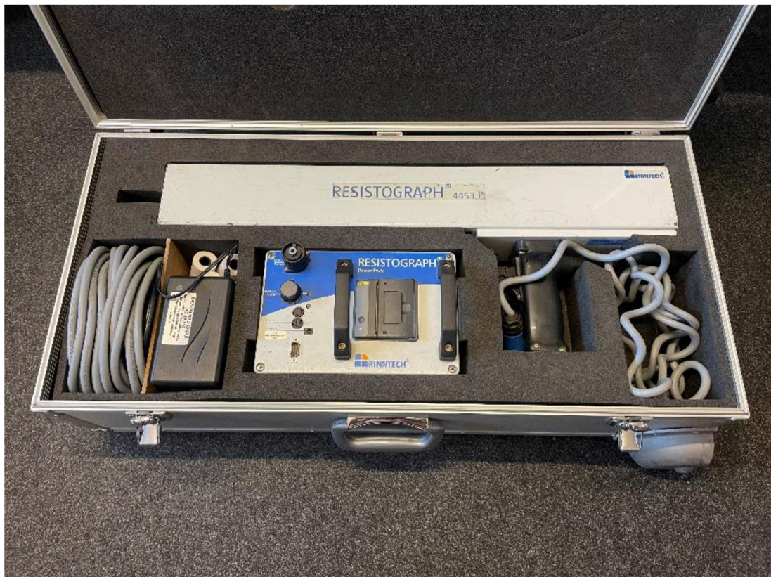
Obrázek 5.4.1: Resistograph 4453-S od firmy RINNTECH se všemi komponenty.
