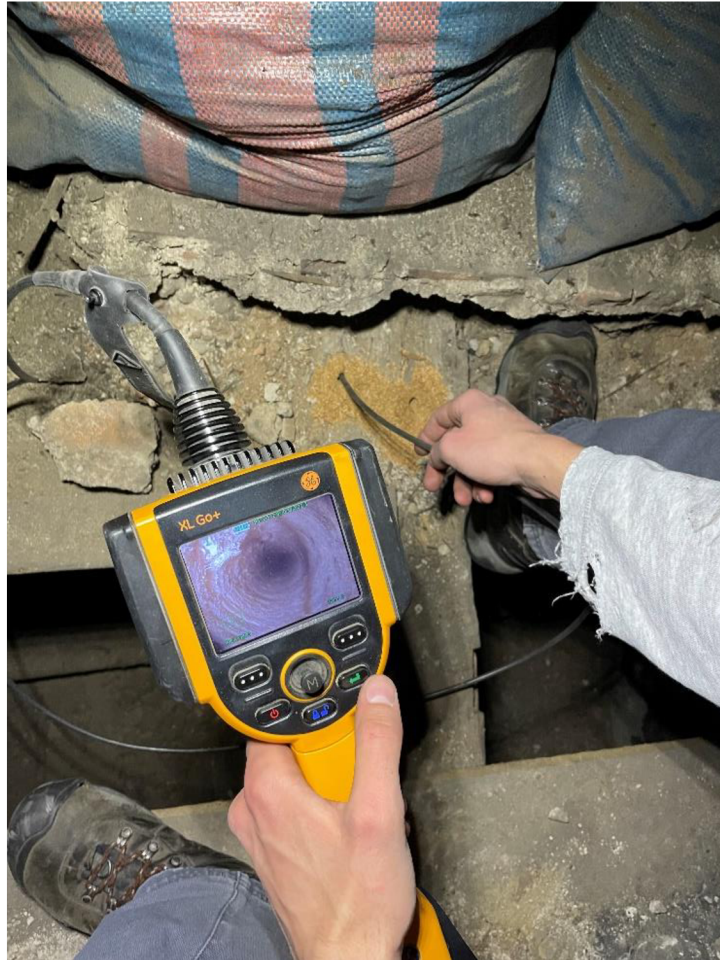
Obrázek 5.3.1.2: Hodnocení vnitřního stavu prvku pomocí endoskopu.
