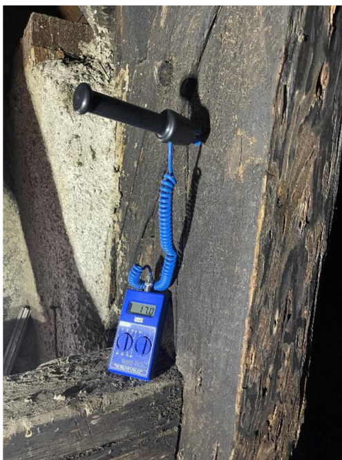
Obrázek 5.1.1.1: Stanovení vlhkosti pomocí odporového vlhkoměru.
