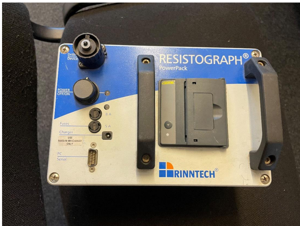
Obrázek 5.4.2: Dobíjecí agregát s baterií, paměťovou kartou a integrovanou termotiskárnou.
