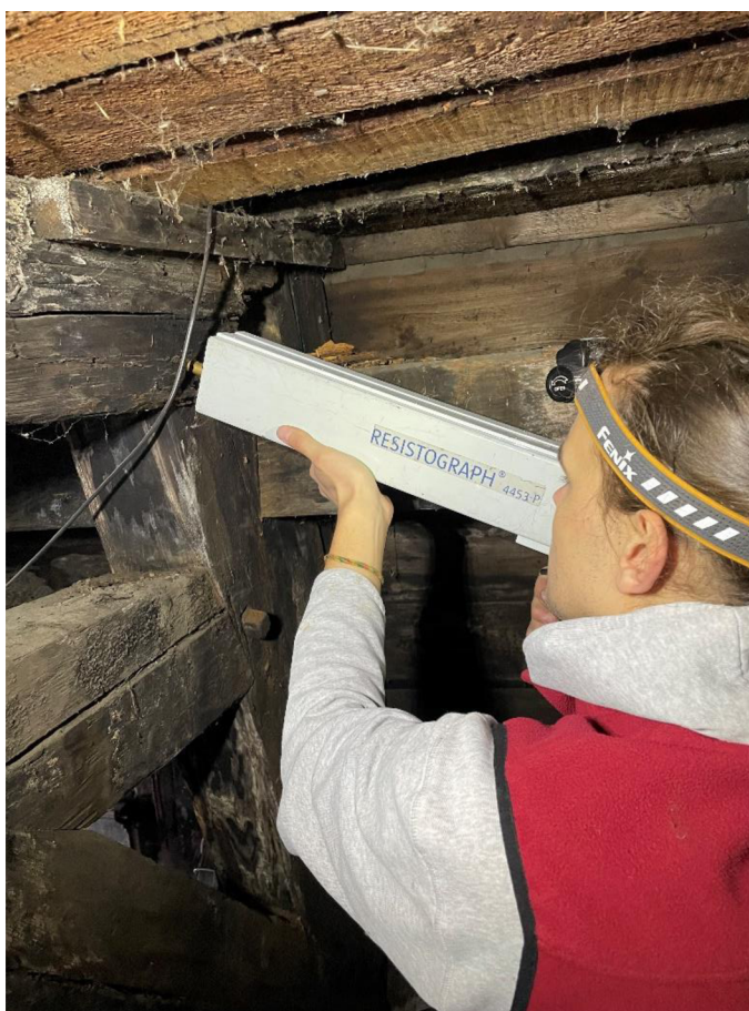
Obrázek 5.4.1.1: Měření poškozeného prvku pomocí Resistographu.
