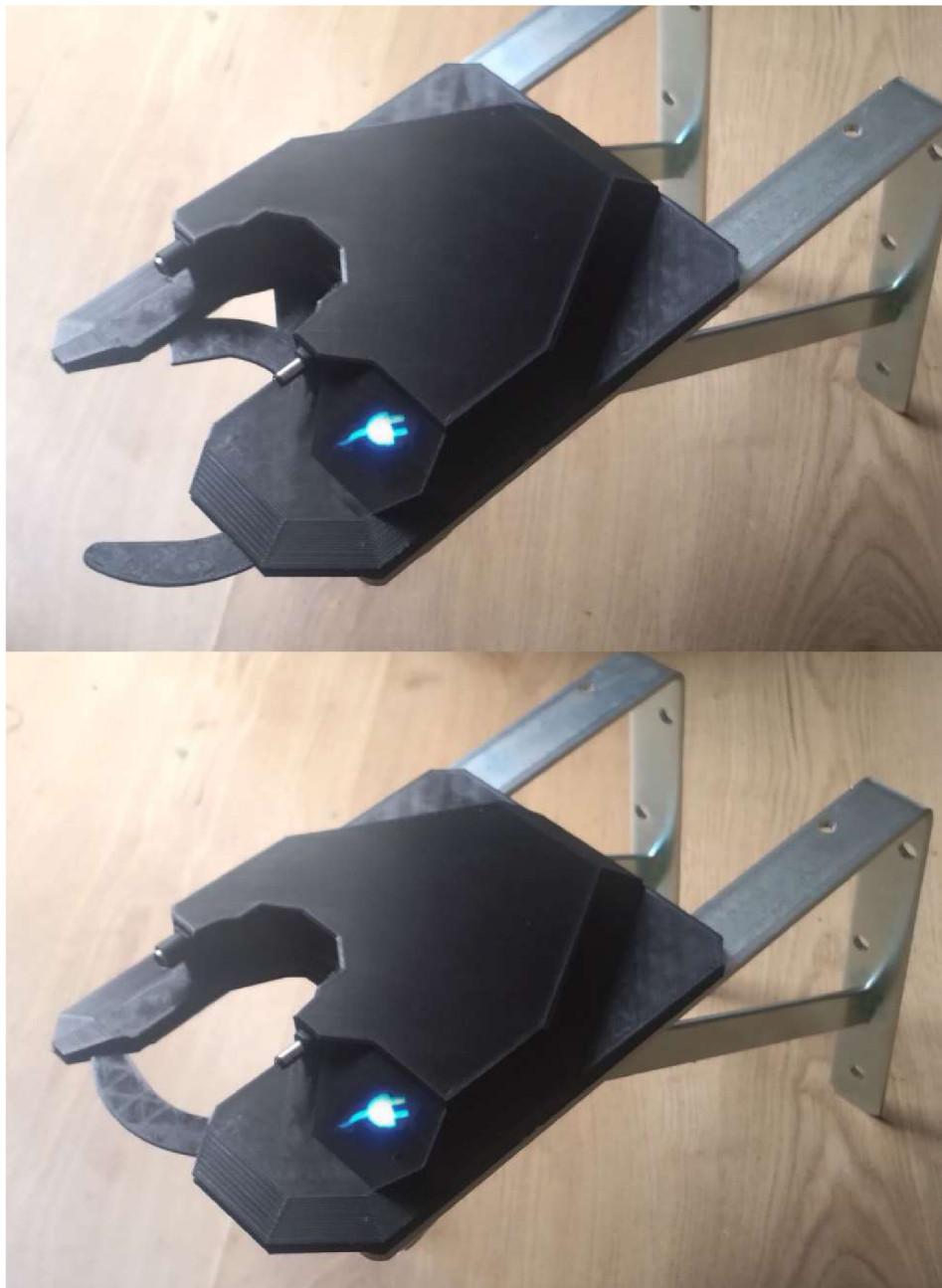
Obrázek 28 - Dok pro koloběžku, nahoře otevřený, dole zavřený
