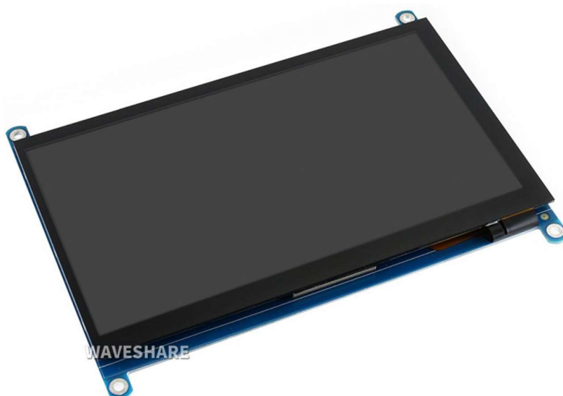
Obrázek 9 - Dotykový displej (Zdroj: waveshare.com [32])
