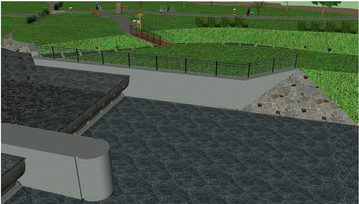
Obr. 8.5 Jez s klapkovými uzávěry a levobřežní opěrnou zdí
