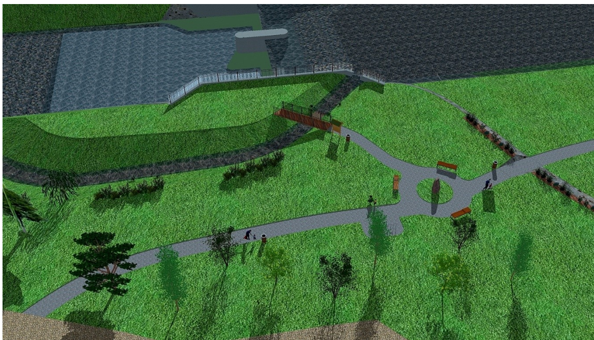
Obr. 8.7 Jez s rybím přechodem a úpravu levého břehu
