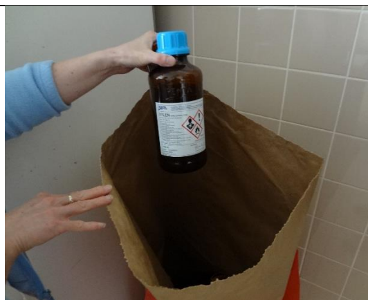
Způsob shromažďování prázdných skaleněných lahví od Xylenu (pařiový obal vložen do plastového červeného pytle určený pro ostré předměty)
