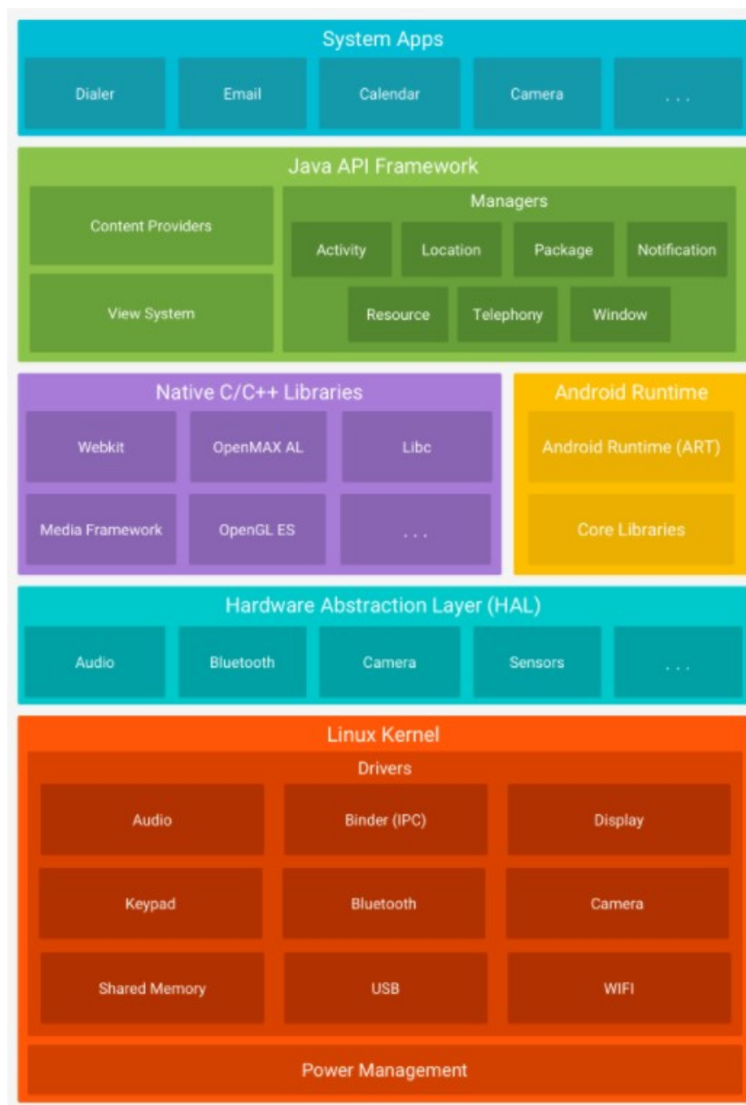
Obrázek 11 Vyobrazení jednotlivých prvků architektury OS Android
