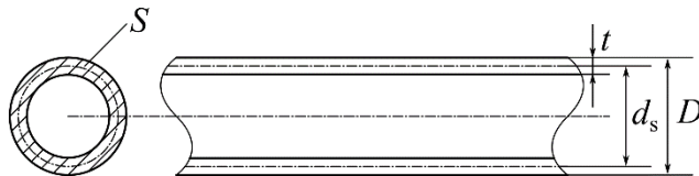
Obr. 16 Určení středního průměru trubky
