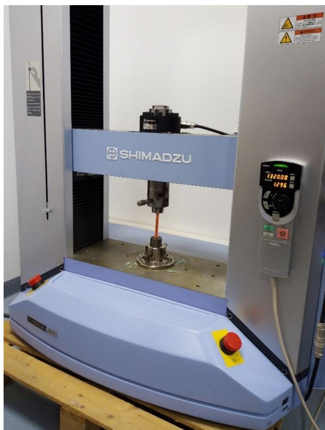
Obr. 9 Trhací stroj Shimadzu
