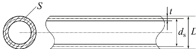
Obr. 16 Určení středního průměru trubky
