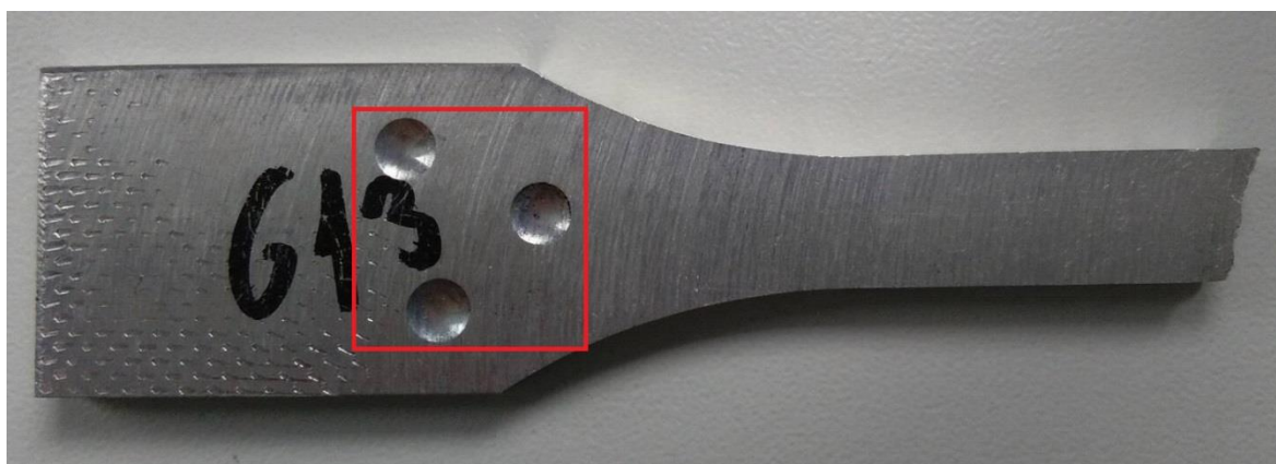
Obr. 36 Vzorek po zkoušce tvrdosti dle Brinella.
