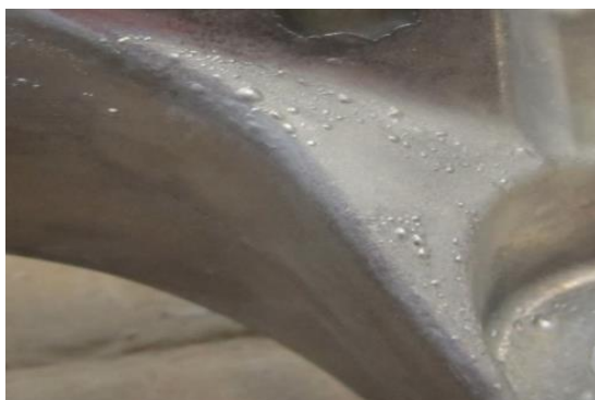
Obr. 23 a , Odlitek po rozpouštěcím žíhání. Obr. 23 b , Odlitek po R.Ž. + vytvrzení.
