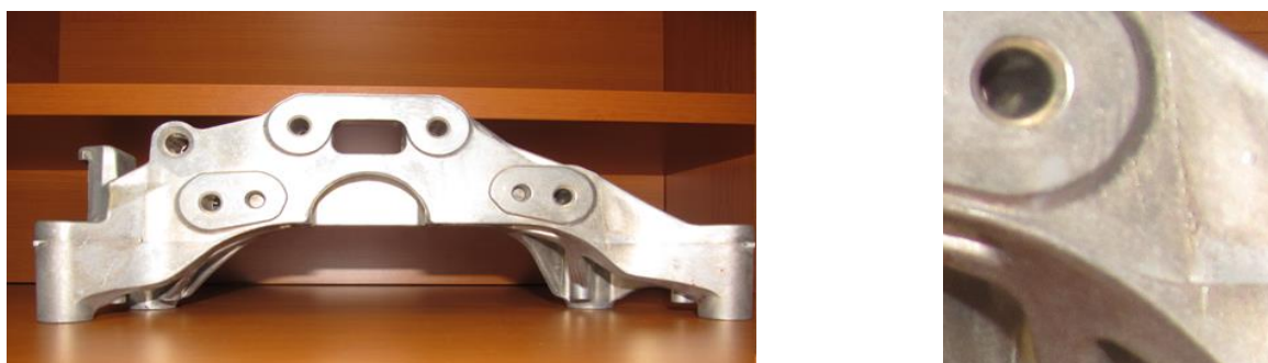
Obr. 21 Držák motoru po TZ vyrobený technologií SEED ze slitiny AlSi7Mg0,3.
