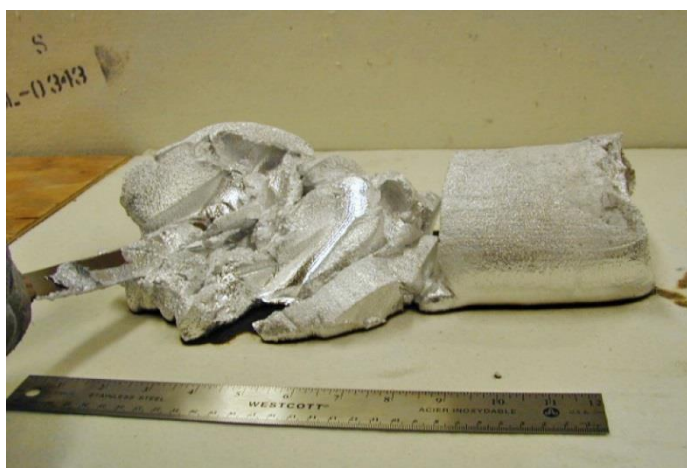
Obr. 1 Deformační chování materiálu v polotuhém stavu. [2]
