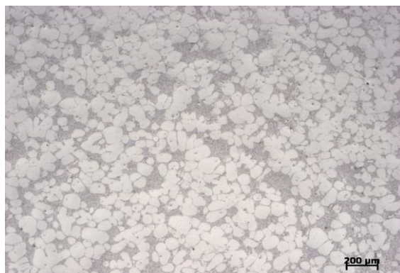
Obr. 46 Mikrostruktura vzorku při režimu tepelného zpracování T6.
