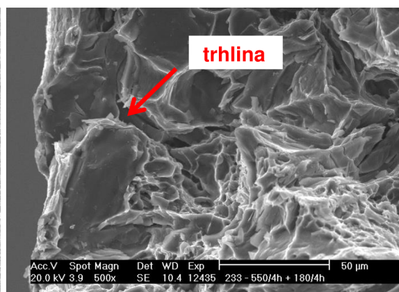
Obr. 61 Křemíková fáze u vzorku 550/4+180/4-3.
