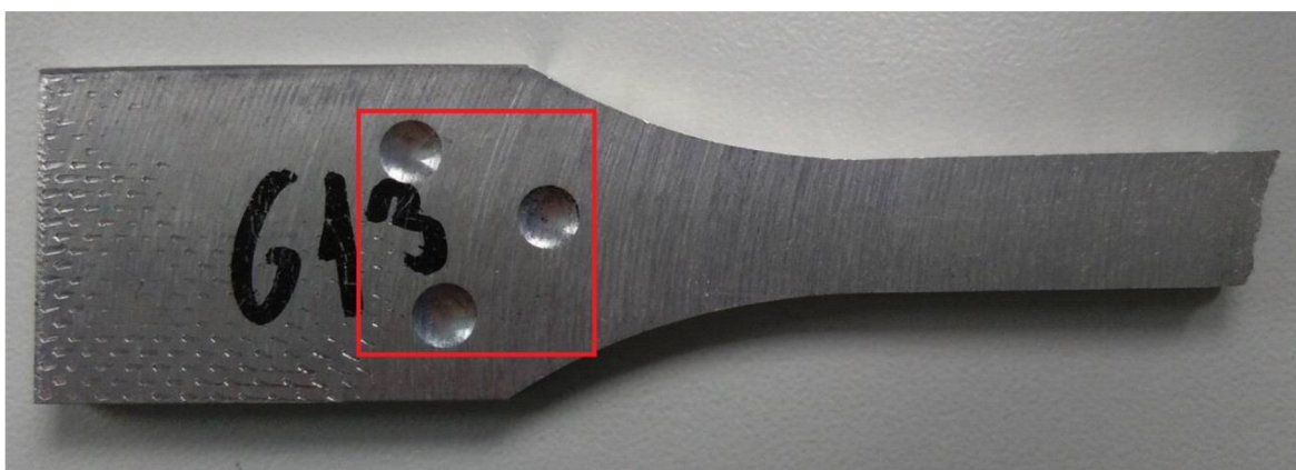
Obr. 36 Vzorek po zkoušce tvrdosti dle Brinella.
