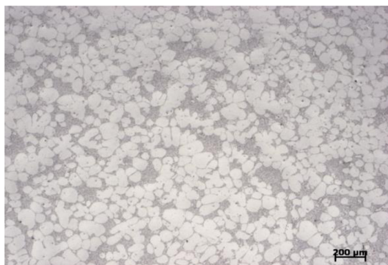
Obr. 46 Mikrostruktura vzorku při režimu tepelného zpracování T6.
