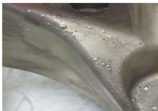
Obr. 23 a , Odlitek po rozpouštěcím žíhání. Obr. 23 b , Odlitek po R.Ž. + vytvrzení.
