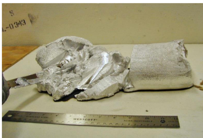
Obr. 1 Deformační chování materiálu v polotuhém stavu. [2]
