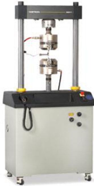
Obr. 4.1: Servohydraulické testovacie zariadenie INSTRON 8801 (Zdroj: http://www.instron.com )
