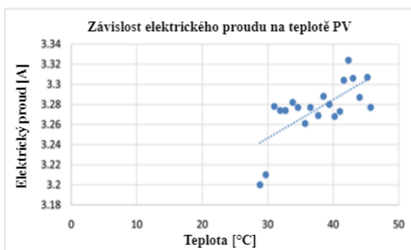
Obr. 5-Závislost elektrického proudu na teplotě fotovoltaického panelu [6]
