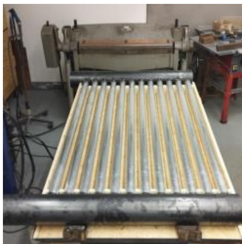
Obr. 55- Solární kolektor typu U/Z využitý v experimentu [104]
