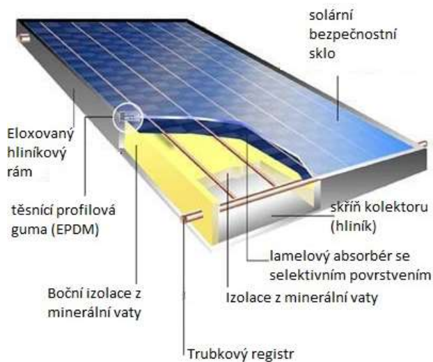
Obr. č. 5: Skladba plochého selektivního kolektoru [10]
