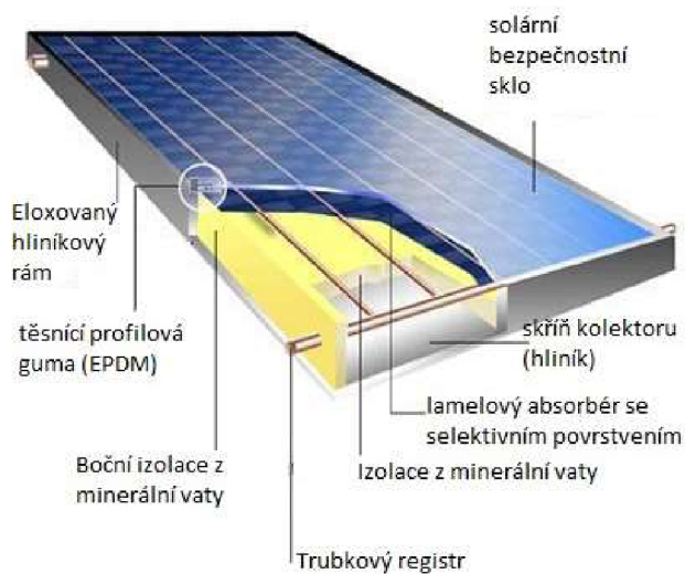
Obr. č. 5: Skladba plochého selektivního kolektoru [10]
