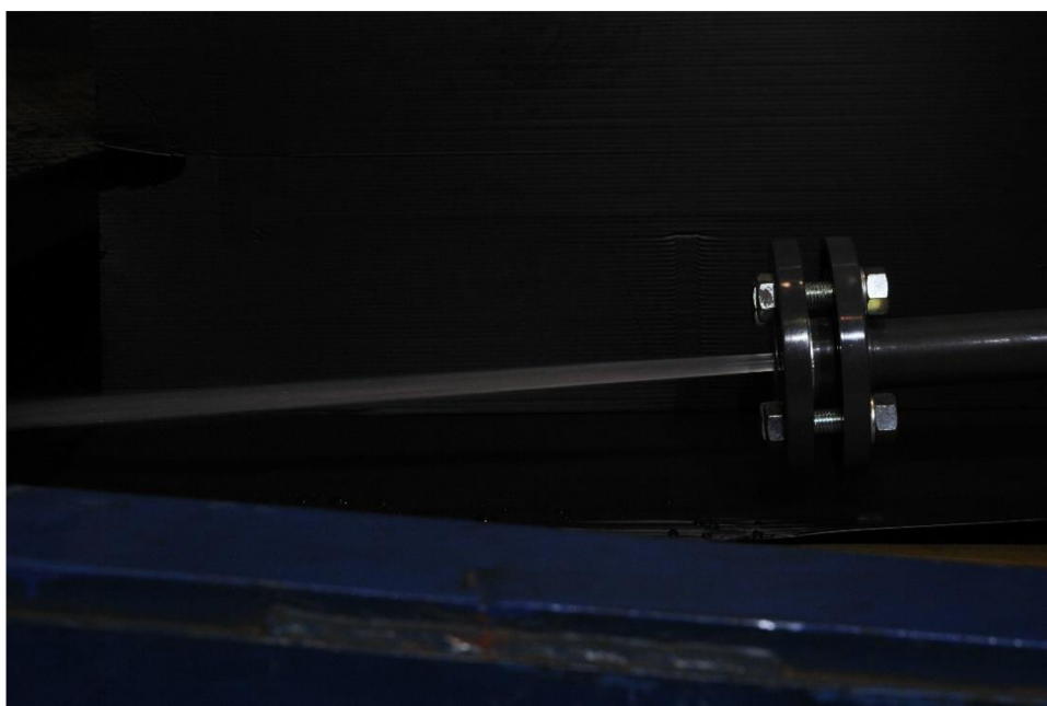
obr. 2.6.4 Vodní paprsek trysky číslo 6 s uklidňující délkou 500 mm
