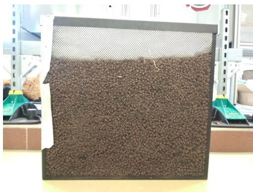
Obr. 3.10: Kazeta s výplní z keramzitu
