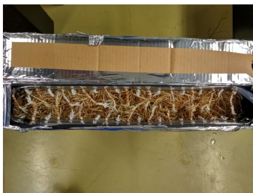
Obr. 3.5: Bavlněné knoty instalované do hadice k distribuci vody
