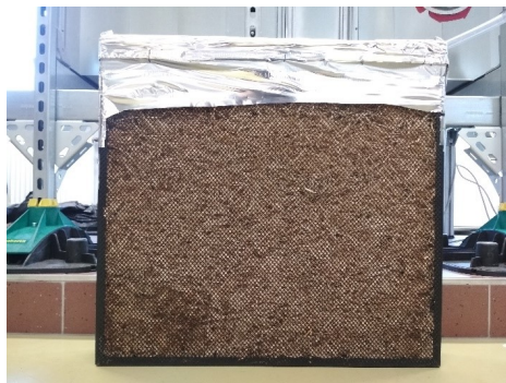
Obr. 3.8: Kazeta s výplní ze dřevovlny
