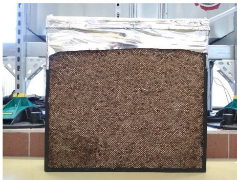
Obr. 3.8: Kazeta s výplní ze dřevovlny
