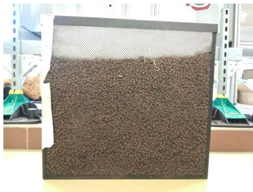
Obr. 3.10: Kazeta s výplní z keramzitu
