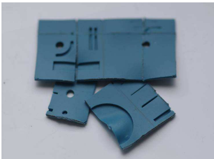
Obr. 28 : Výpalem zdeformovaná struktura vytvořená LTCC keramikou DuPont 951
