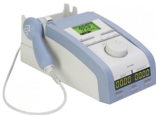
Obrázek 52: Ultrazvukový přístroj BTL 4000, USA. Na obrázku je vidět digitální displej pro nastavení požadovaných hodnot. Při ukončení ozvučení vydá přístroj zvukové upozornění a vypne se [87]
