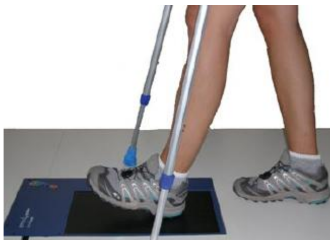
Obrázek 2. Měření vertikální složky reakční síly při nácviu zatížení postižené dolní končetiny (Klöpfer-Krämer & Augat, 2010, 16)
