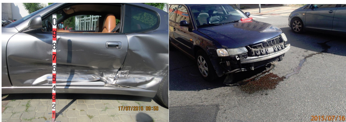
Obr. 11 Zaměření rozsahu poškození vozidla Maserati a fotografie vozidla viníka Volkswagen (Zdroj ČPP, a.s.)
