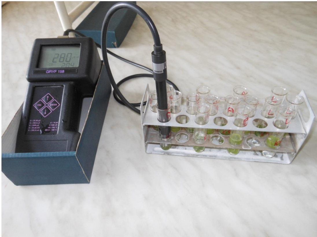
Obr. VII: Měření vodivosti pomocí konduktometru (foto autor)
