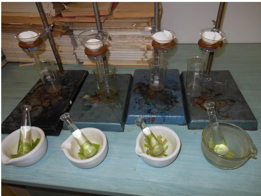
Obr. IX: Příprava filtrátu pro stanovení obsahu prolinu (foto autor)
