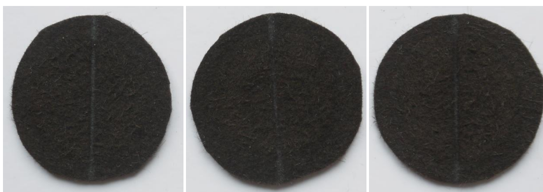
Obr. č. 34 Tři druhy vzorků s vypálenou drážkou po 100, 150 a 200 otáčkách (zobrazeno z leva doprava)
