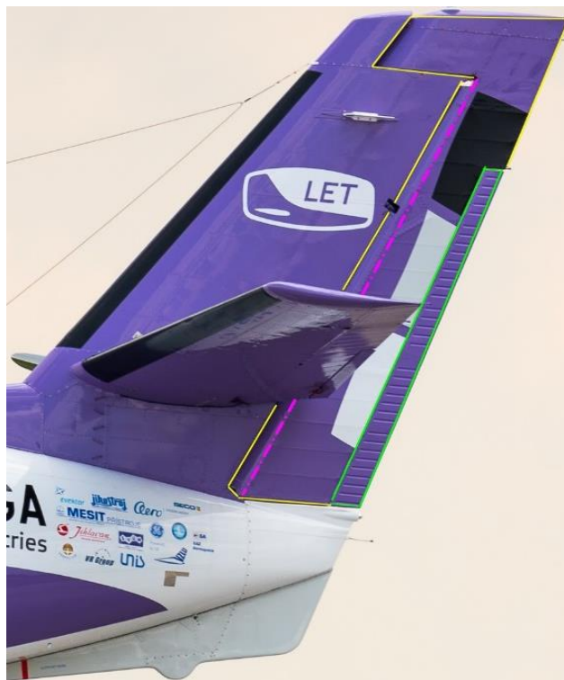
Obr. 13. Směrové kormidlo letounu L 410 NG [3]
