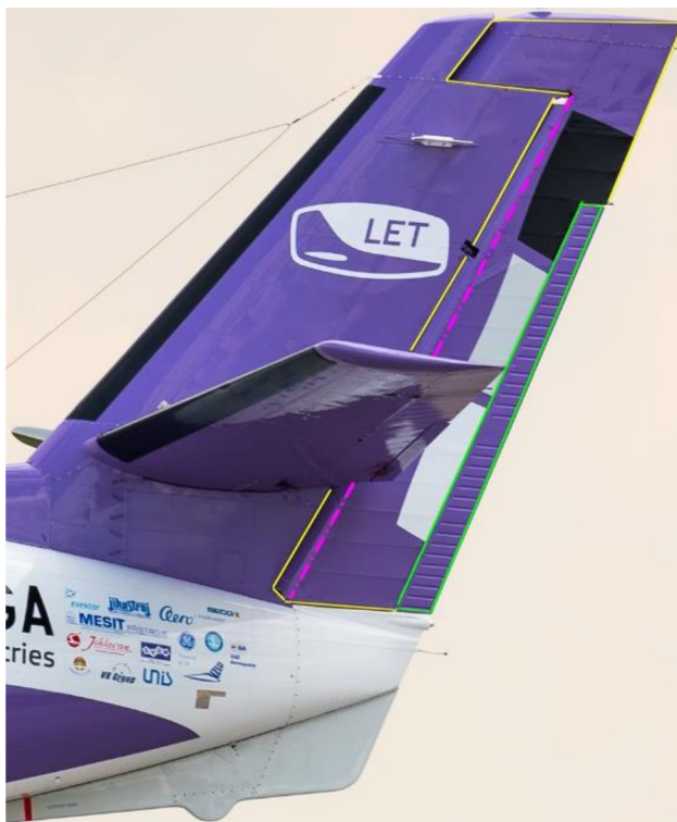
Obr. 13. Směrové kormidlo letounu L 410 NG [3]
