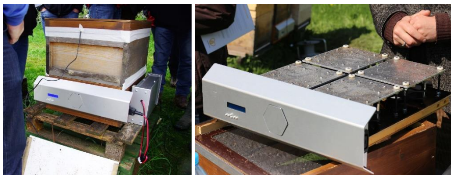
Obr. 12: Bienensauna při termoterapii (vlevo) a jeho elektronická část (vpravo). (Ingo 2015)
