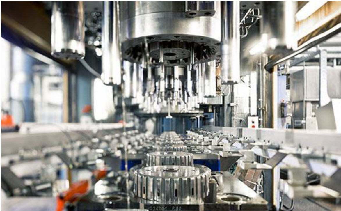
Obr. 1 Proces výroby součástí přesným stříháním [17]
