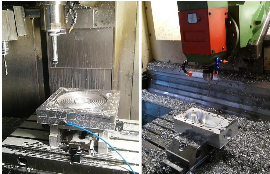
Obr. 70 – Frézování vnitřní oblasti ve statorové desce (vlevo) a v odtokovém dílu (vpravo) na CNC stroji
