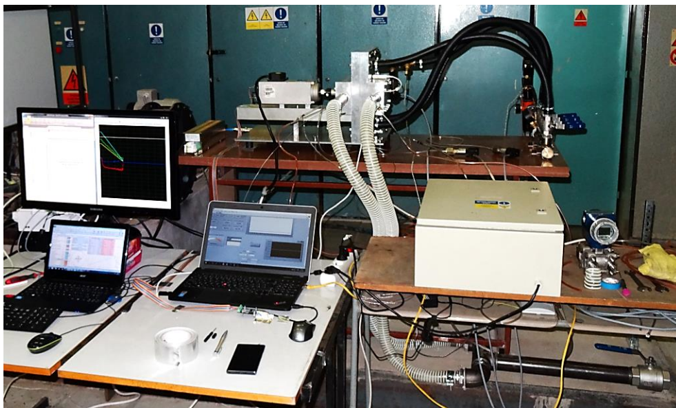
Obr. 76 – Zapojení měřicí aparatury bezlopatkové turbíny při experimentálním měření
