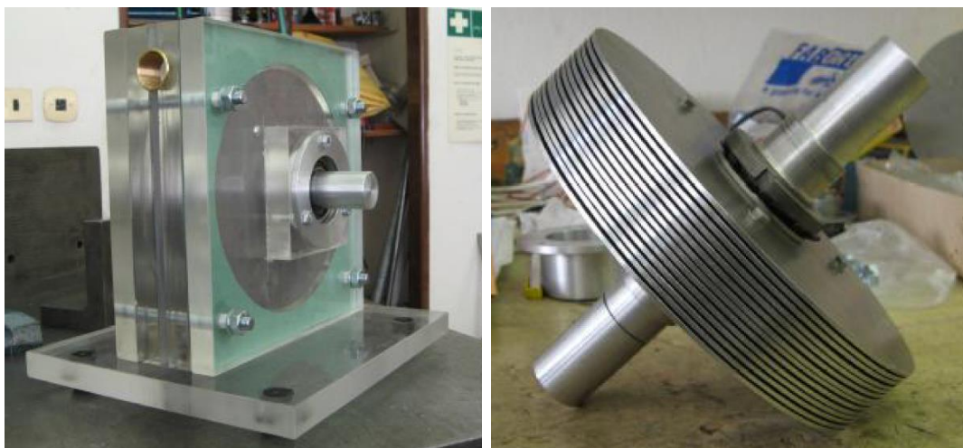
Obr. 24 – Měřicí aparatura při testování modelu bezlopatkové turbíny (nalevo) a odhalený rotor modelu turbíny se vstupní tryskou (napravo) [26]
