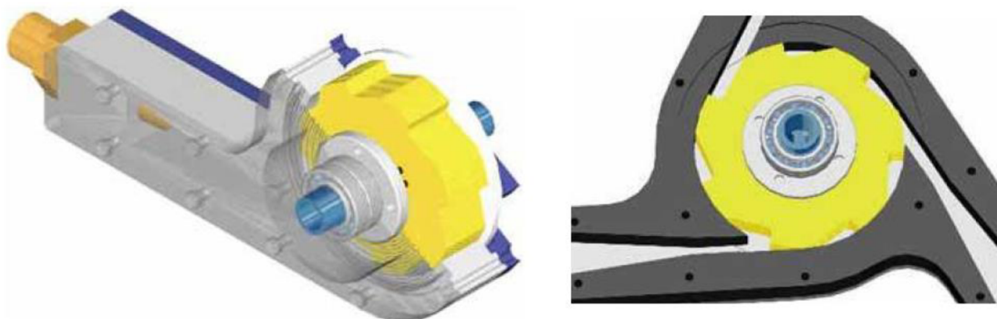
Obr. 14 - Rotor turbíny opatřený výřezy po obvodu [3]
