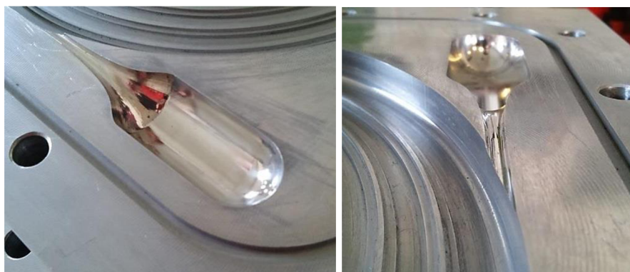
Obr. 71 – Výsledek lapování vyfrézované poloviny trysky ve statorové desce
