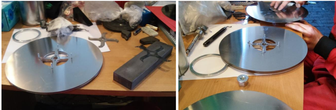
Obr. 68 – Zbavování ořepů a ostřin rotorových disků a distančních prvků po vypálení CNC laserem
