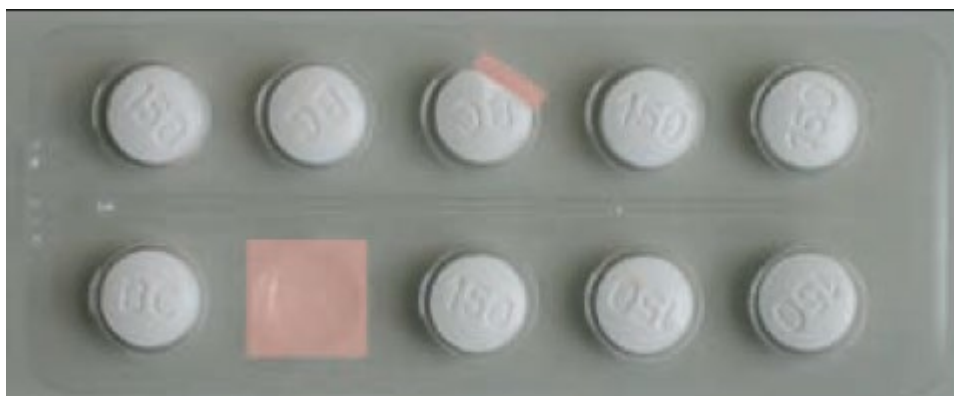
Obr. 2.4 Příklad úlohy počítání: kontrola naplnění blistru s léky[2]
