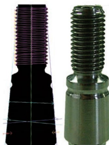
Obr. 2.5 Příklad úlohy kontroly tolerancí: měření závitů na kulovém čepu[2]
