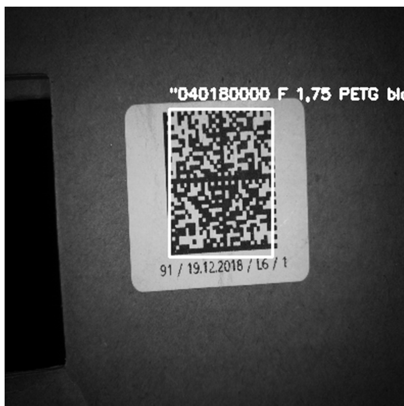
Obr. 7.2 Ukázka čtení čárového kódu typu Datamatrix knihovnou pylibdmtx
