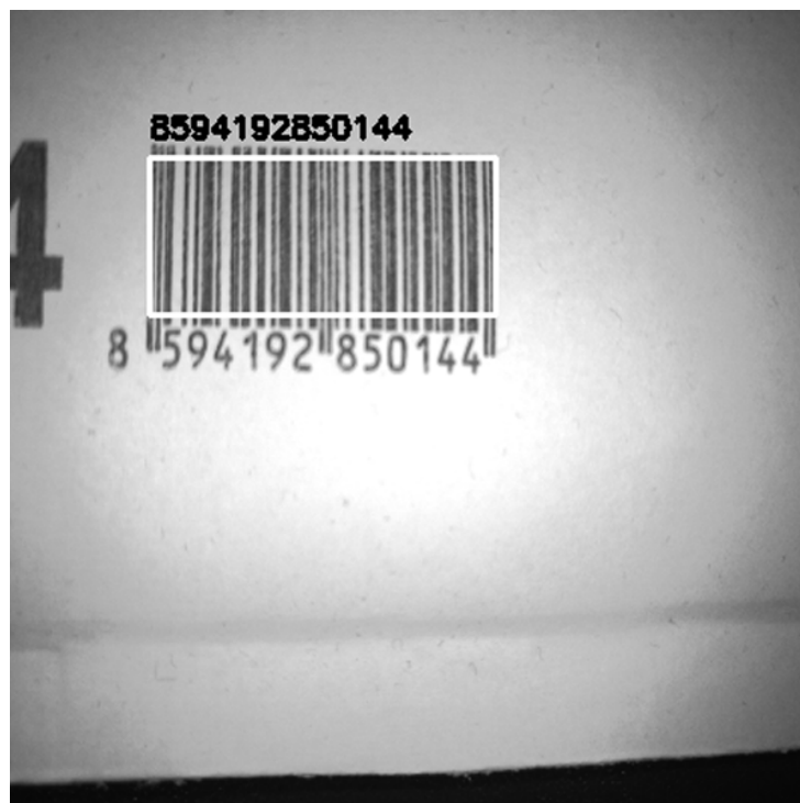
Obr. 7.1 Ukázka čtení čárového kódu typu EAN13 knihovnou pyzbar
