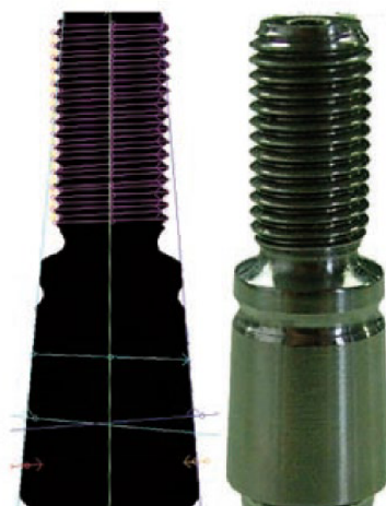
Obr. 2.5 Příklad úlohy kontroly tolerancí: měření závitů na kulovém čepu[2]
