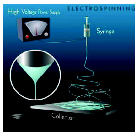
Obrázek 1: Princip výroby nanovláken
