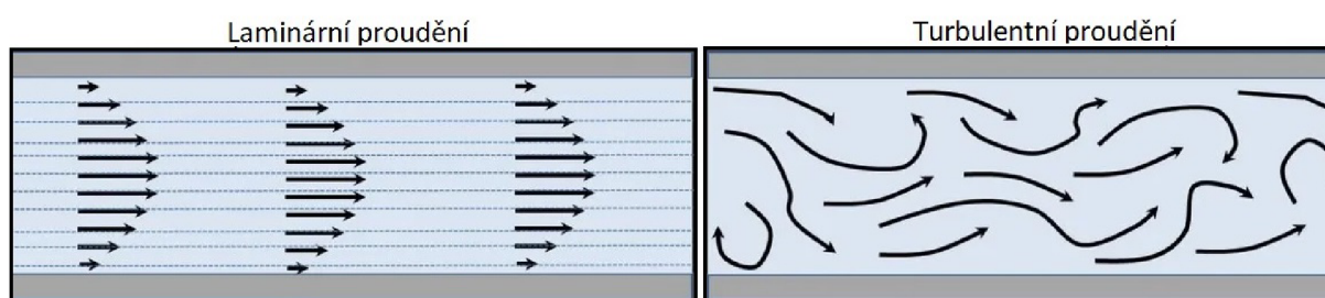
Obrázek 2.2: Rozdíl mezi laminárním a turbulentním prouděním (upraveno) [65]
