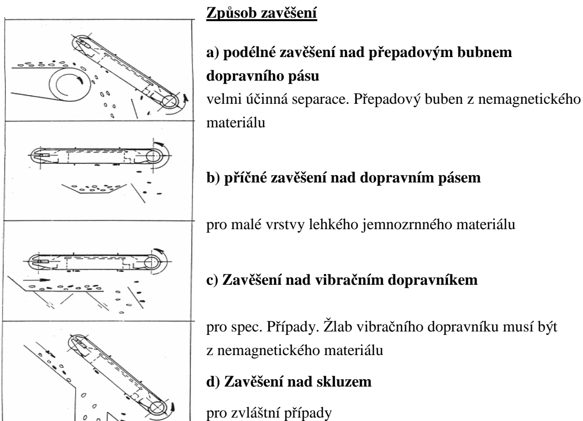
Obr. 7 Způsob zavěšení magnetických separátorů
