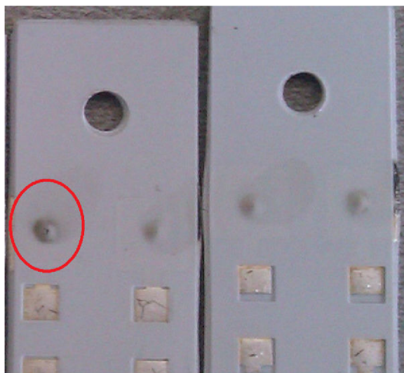
Obr. 17: Pohled na pokles materiálu v okolí prokovu a jeho vystoupenutí a prasknutí.
