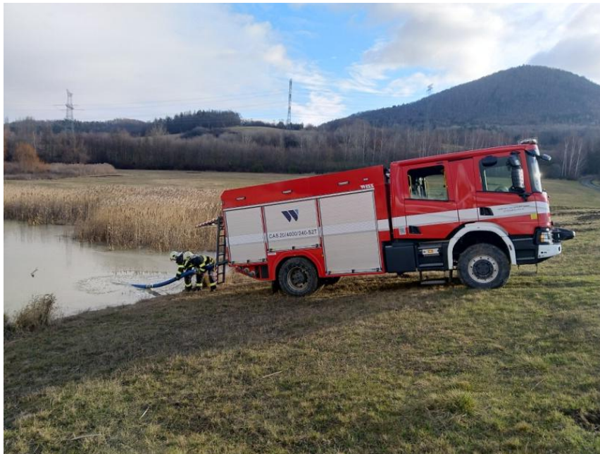
Obr. 6: Vodní nádrž Kostomlaty I, zkouška zřízení čerpacího stanoviště na nezpevněném povrchu
