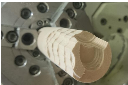
Obr. 41 Odladěná operace hrubování odvrtáním
