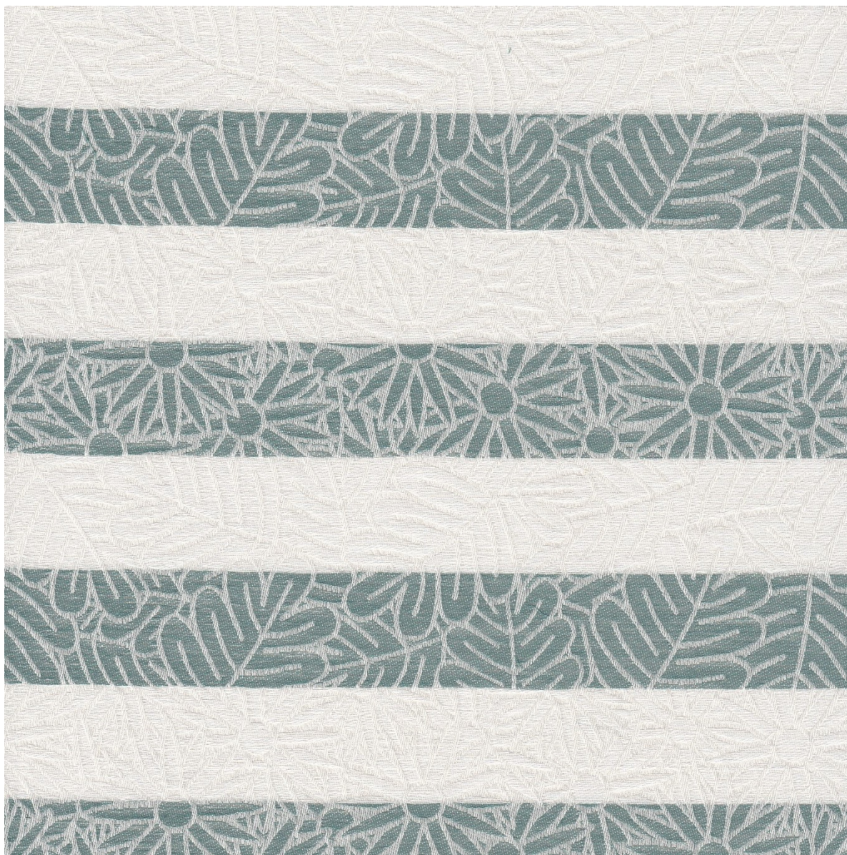
Obrázek 171 - Dezén „Kytice“ s barevným házením "0,5 vazebné střídy, 2 barvy, stejně dlouhé pruhy, ostrý přechod barev"
