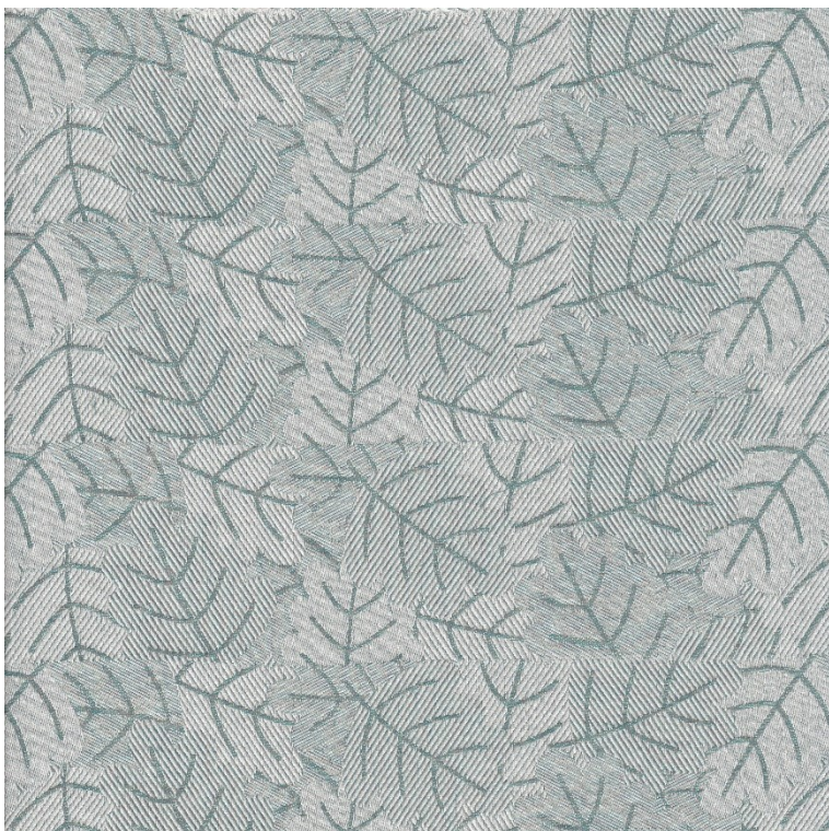
Obrázek 104 - Dezén "Více vazebné listy" s keprovými a atlasovými vazbami, bez kontur, vytkaný v kombinovaném efektu
