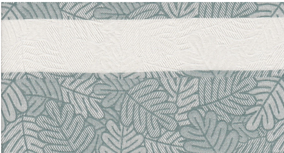
Obrázek 163 – Dezén „Vícevazebné listy“ s keprovými a atlasovými vazbami, s konturami - s barevným házením "2 barvy, různě dlouhé pruhy, ostrý přechod barev"
