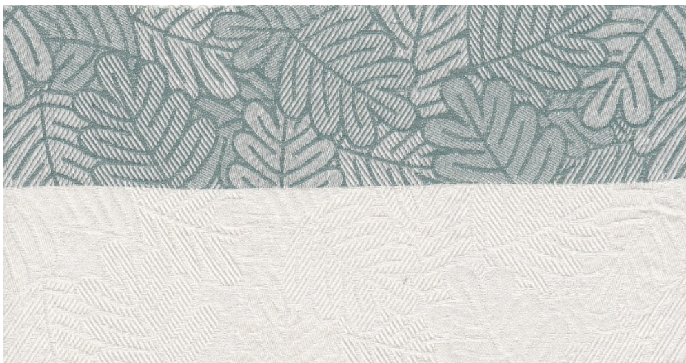
Obrázek 153 – Dežén „Vícevazebné listy“ s keprovými a atlasovými vazbami, s konturami - s barevným házením "2 barvy, stejně dlouhé pruhy, ostrý přechod barev"
