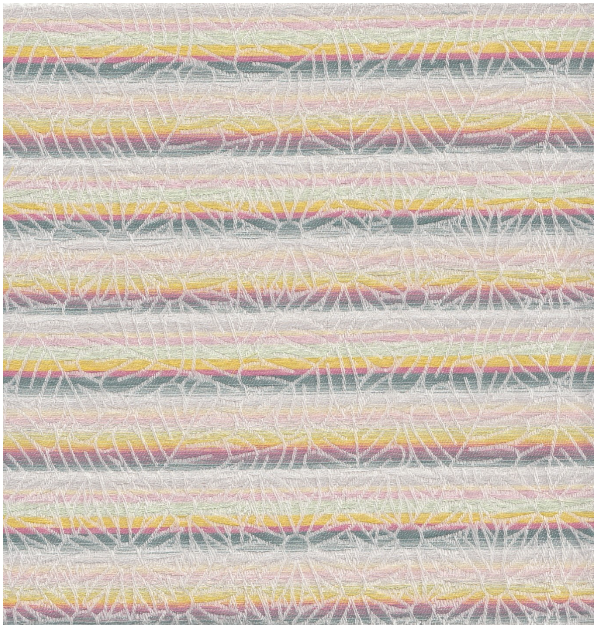
Obrázek 177 - Dežén „Kytice“ s barevným házením "0,25 vazebné třídy, 8 barev, různě dlouhé pruhy, kombinace ostrého a plynulého přechodu barev"
