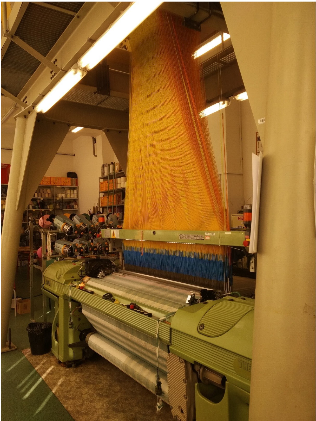
Obrázek 136 - Pohled na tkací stroj Somet využitý pro experimentální část BP s odvíječi útku a šňůrami žakárského mechanismu
