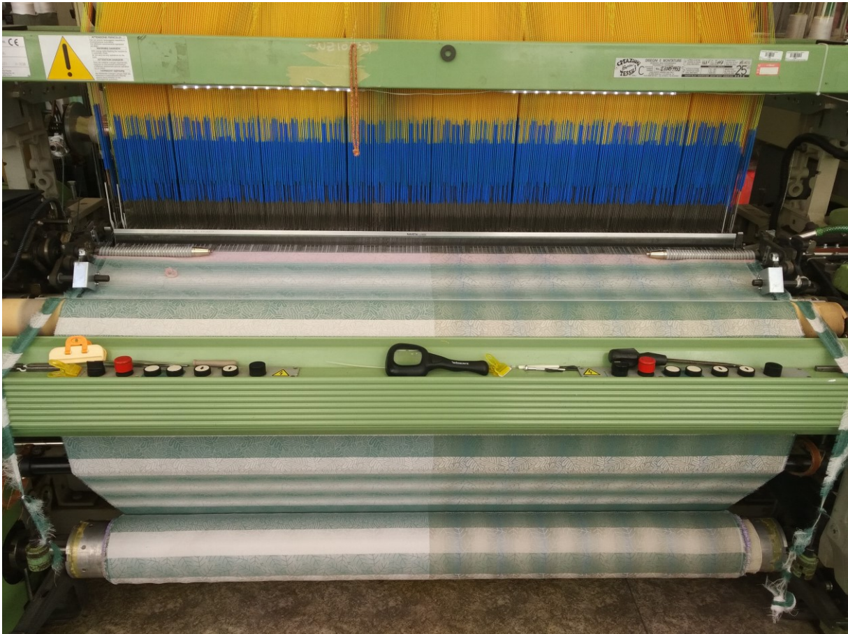
Obrázek 76 - Pohled na tkací část stroje s nitěnkami a hotovou tkaninou
