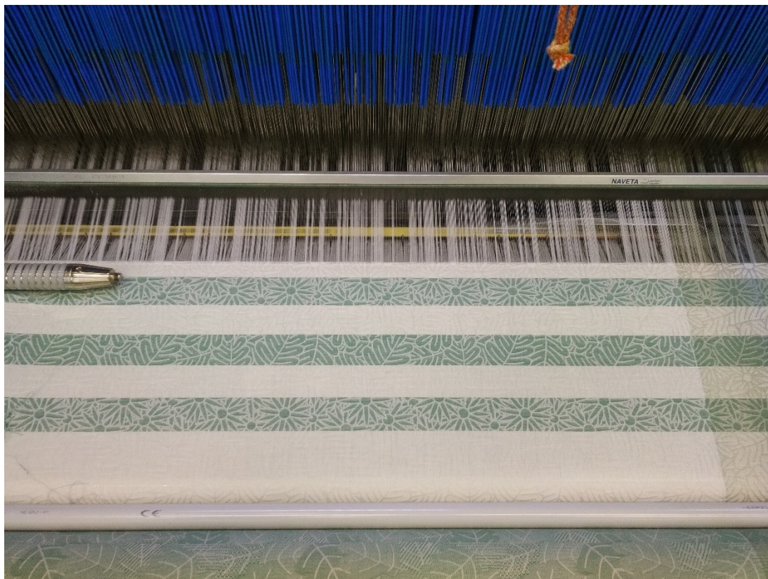
Obrázek 137 - Proces tkaní dezénu "Kytice" se dvěma barvami v útku – fáze zanesení útku
