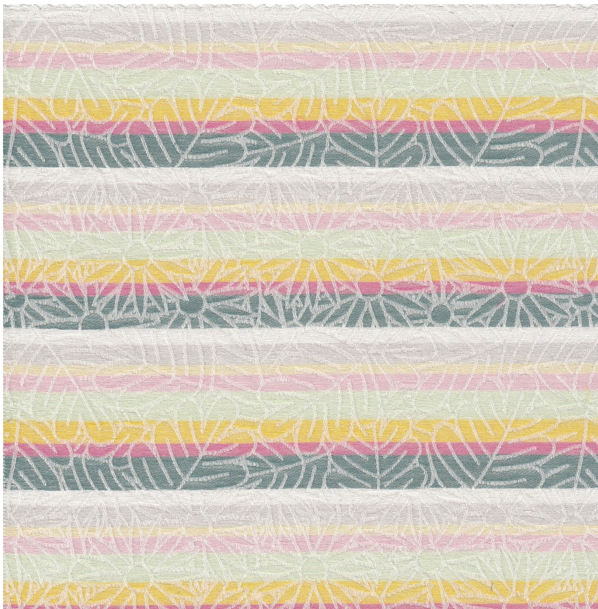
Obrázek 174 - Dezén „Kytice“ s barevným házením "0,5 vazebné střídy, 8 barev, různě dlouhé pruhy, ostrý přechod barev"
