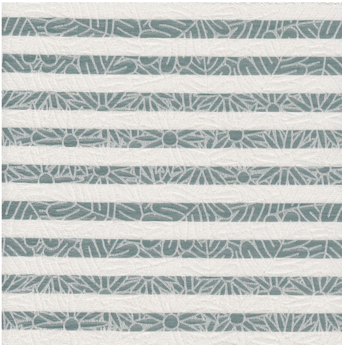
Obrázek 178 - Dezén „Kytice“ s barevným házením "0,2 vazebné střídy, 2 barvy, stejně dlouhé pruhy, ostrý přechod barev"
