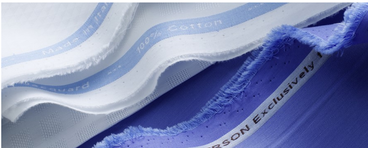
Obrázek 13 - Dekorované kraje tkaniny pomocí žakárského stroje N4L [7]
