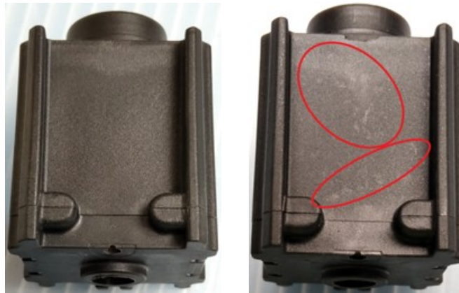
Obr. 18) OK vzorek bez map (vlevo) a NOK vzorek s mapami (vpravo)
